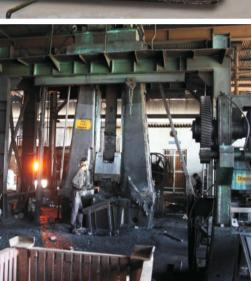
Close Die : 3 Tonne MPM Hammer, 1 Tonne Belt Rope Hammer
